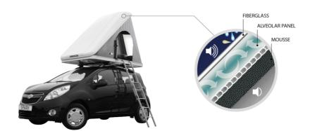
Der neue Dachhimmel mit Mehrschicht-Isolierung, exklusiv bei Autohome. Dank eines Luftpolsters, welches durch eine Hohlkammerplatte gebildet wird und einer isolierenden Schaumschicht, erhalt man einen sehr guten Larm- und Warmeschutz ohne Gefahr von Kondenswasserbildung. Angenehmer, warmer und leiser selbst bei Hagel!
