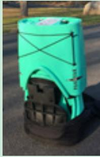
Verstauen Sie nun die zwei verbleibenden Cockpithälften. **Das größere (Heck) Teil zuerst.** Stecken Sie dann noch den Sitz vorne unten in die Tasche mit der Unterseite nach außen.
