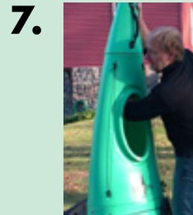
7. Entfernen Sie das Bugstück aus der Tasche und legen Sie es auf den Bugturm (entfernen Sie das schwarze Polster und befestigen Sie es an einem Riemen der Tasche). Greifen Sie nach oben in die Luke und verriegeln Sie die 3 Klammern. Lukendeckel wieder aufsetzen.
