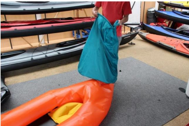
Den Befüllsack nach oben ziehen und dann zuwickeln. Dadurch wird die Luft im Sack „gefangen“...
