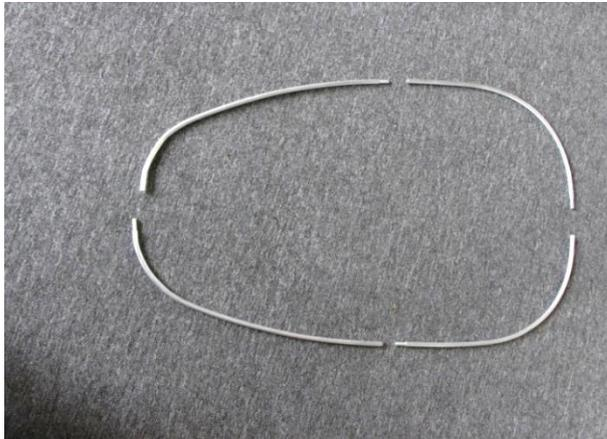
Nehmen Sie die vier Einzelteile des Süllrands zur Hand und legen Sie sich diese so zurecht, dass sich die beiden langen gebogenen Teile und die beiden kürzeren gebogenen Teile gegenüber liegen (siehe Abbildung links).
