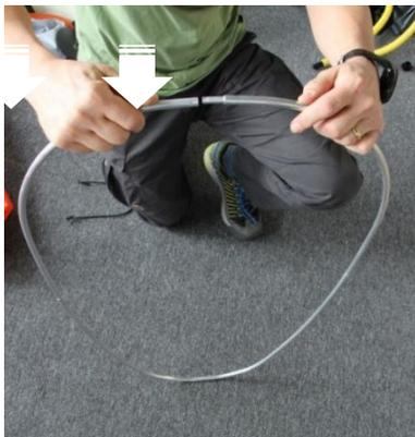
Stellen Sie dann den Süllrand auf den Boden und drücken Sie die oberen Alustangen **leicht** nach unten (so dass diese in einer Geraden zueinander stehen) und führen Sie dann diese Verbindung zusammen.
