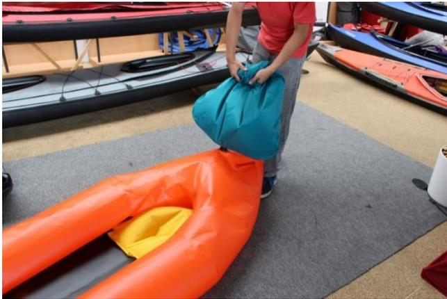
Nach 7-8 Stößen ist genügend Luft im Boot. Dann den Befüllsack aus dem Ventil nehmen und das Ventil wieder zudrehen.
