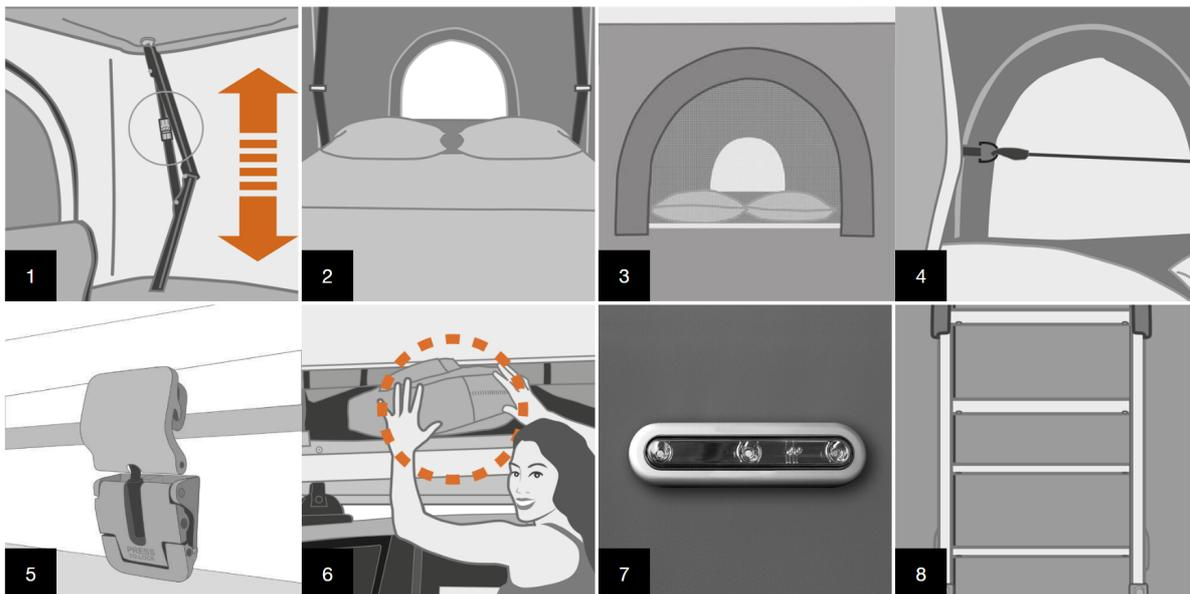
1 - Serienausrüstung 4 Gasfedern zum automatischen Öffnen in 2 Phasen.
