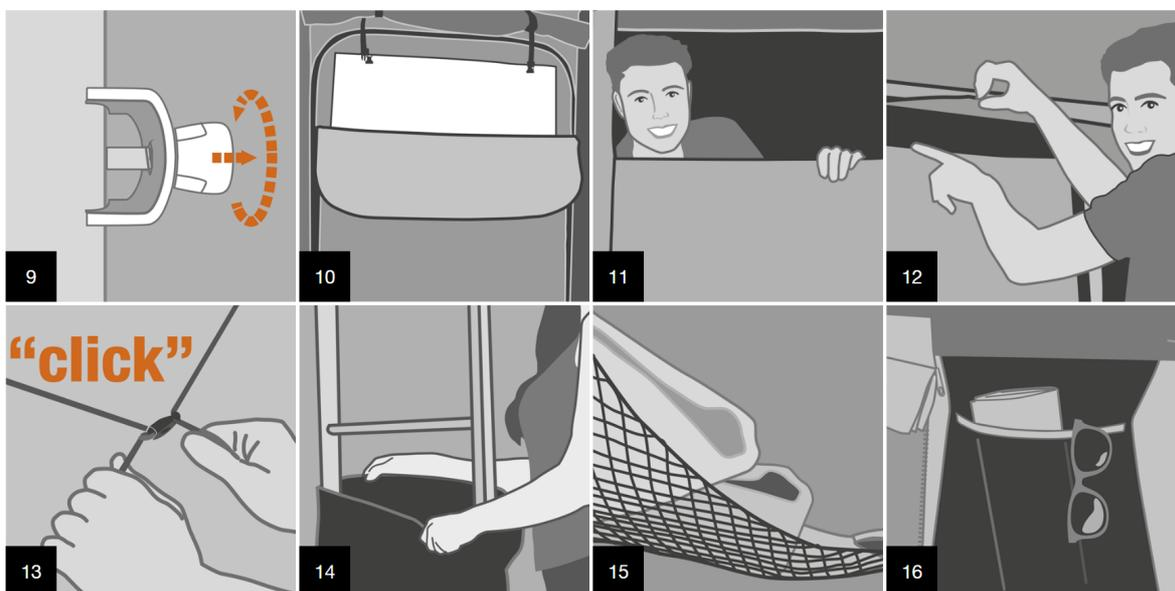
9 - Der serienmäßige automatische Federhaken blockiert die Leiter wenn sie geöffnet ist. Dadurch wird die Rutschgefahr verhindert und die Leiter steht stabil und sicher auf jedem Boden.
