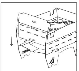
**3.** Stecke das lose kurze Seitenteil (4) mit den zwei schrägen Schlitzen auf die beiden Nasen des Abstrahlblechs (5).
