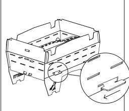
**4.** Platziere die Verbindungsfugen des kurzen Seitenteils (4) direkt über denen der langen Seitenteile (1 & 3) und drücke das kurze Seitenteil (4)nach unten. Verriegele nun die Bodenplatte (7) bis es hörbar klickt.
