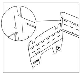
1. Stecke das lange Seitenteil (1) auf der Seite mit Skotti-Logo und das kurze Seitenteil (2) an der Verbindungsfuge ineinander. Beide Teile sind an der Verbindungsfuge mit einem kleinen Dreieck gekennzeichnet.
