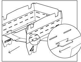
**3.** Lege die Bodenplatte (7) mit der Wölbung nach unten zwischen die drei aufgebauten Teile. Die beiden gekennzeichneten Nasen (Dreieck) zeigen nach innen, die äußeren Haken müssen auf Höhe der Schlitze sein.
