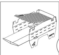
**5.** Schiebe jetzt das Holzfeuerblech (6) auf die Bodenplatte (7) in den SKOTTI MINI. Lege danach den Grillrost (8) mit der Nase Richtung offene Seite in die hinteren dafür vorgesehenen Aussparungen. Lasse den Grillrost (8) dann in die vorderen Aussparungen gleiten. Schiebe
