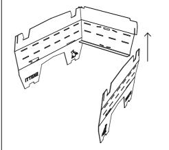
**2.** Stecke das kurze Seitenteil (2) und das zweite lange Seitenteil (3) an der schmalen Verbindungsfuge auf der Seite mit Skotti-Schriftzug ineinander.
