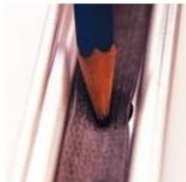
Gummifelgenband drückt sich in Bohrung
